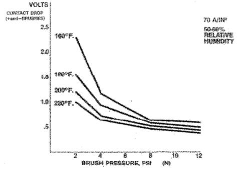
**GRAPH III EFFECT OF PRESSURE ON VOLTAGE DROP**
